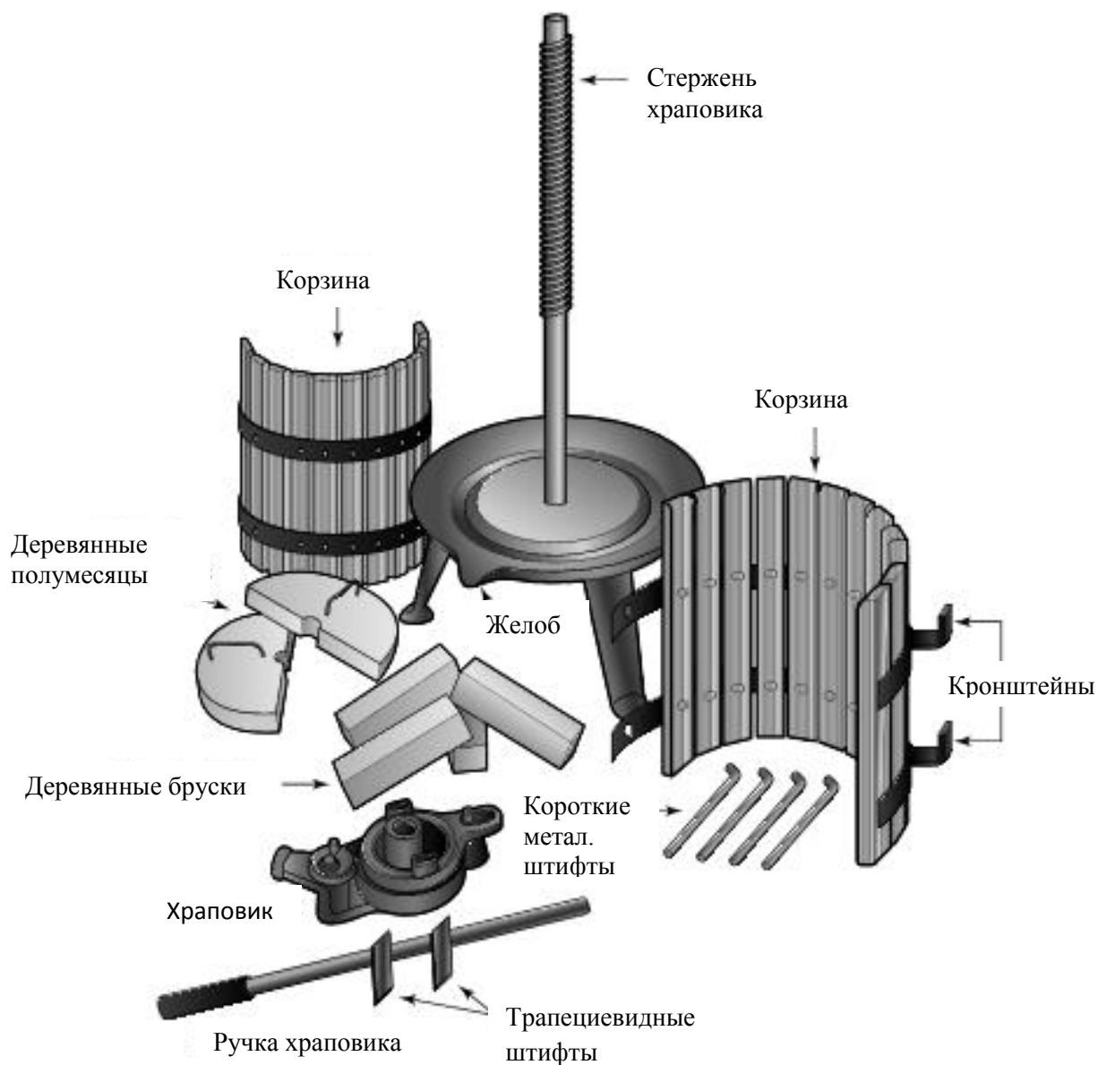
Рисунок 5-2: Пресс в разобранном виде.
